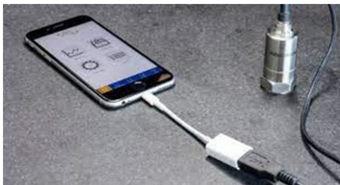
Figura 6.11 Aquisição de vibrações com acelerómetro digital e armazenamento em smartphone .
