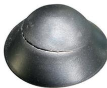
Figura 6.25. Aspecto do rompimento de uma chapa ensaiada numa máquina Erichsen.<sup>[343]</sup>
