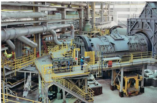
Figura 5.59. Forno de refinação para a produção de ânodos.<sup>[250]</sup>
