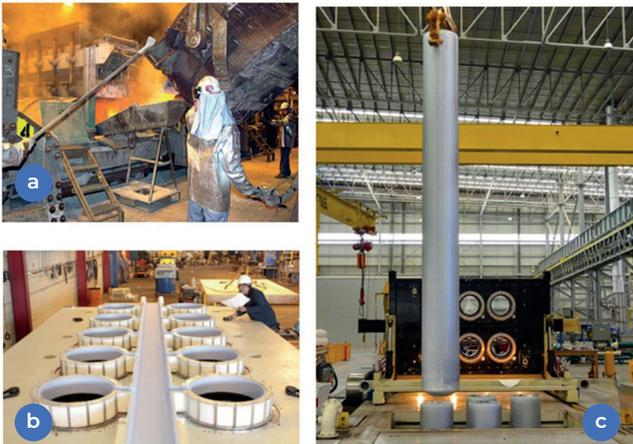
Figura 5.52. Produção industrial de *biletas* de alumínio: a) vazamento;<sup>[241]</sup> b) sistema de enchimento dos *biletas*;<sup>[242]</sup> c) remoção dos *biletas*.<sup>[243]</sup>
