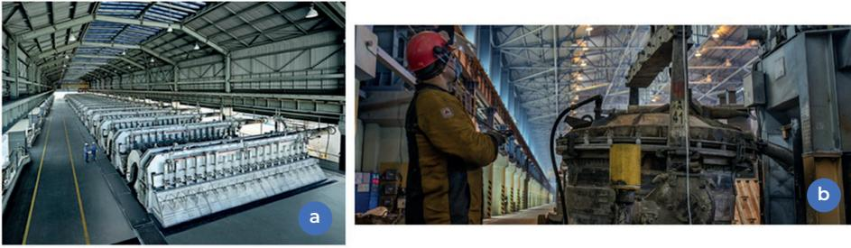
Figura 5.50. Produção de alumínio em célula Hall-Héroult: a) instalação industrial com várias células em funcionamento;<sup>[238]</sup> b) painel de transferência.<sup>[239]</sup>
