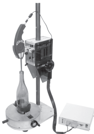
Figura 15.2. Sistema automático de medição de interiores, vulgarmente utilizado na caracterização dimensional do perfil interno do gargalo das garrafas.
